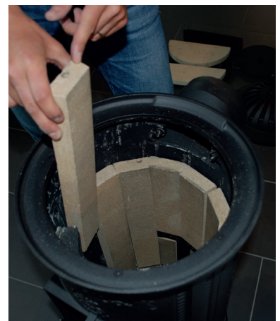
5. Entnehmen Sie die Feuerraumauskleidung nach oben.
