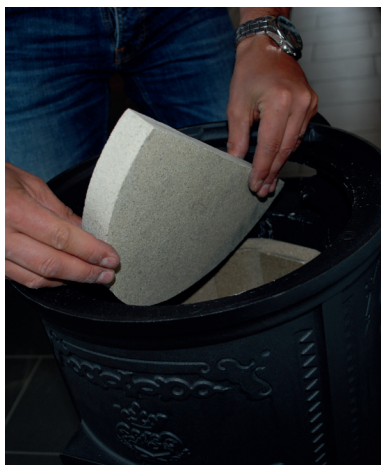
3. Entnehmen Sie den Eisenwinkel, dann die vordere Rauchumlenkung und dann die hintere. So können Sie nun der Ofen gut reinigen.
