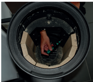
4. Lösen Sie die 3 Schrauben auf jeder Seite und schieben Sie die Bleche hinaus - nach vorn
